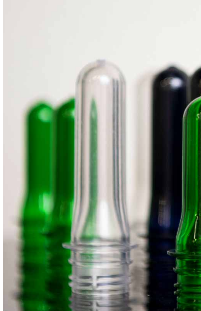
Auf Basis fingernagelgrosser Flakes und weiterer Arbeitsschritte produzieren Preform-Hersteller reagenzglasförmige Rohlinge, die von den Getränkeherstellern zu neuen PET-Flaschen aufgeblasen werden.
