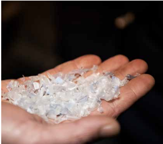
Auf Basis fingernagelgrosser Flakes und weiterer Arbeitsschritte produzieren Preform-Hersteller reagenzglasförmige Rohlinge, die von den Getränkeherstellern zu neuen PET-Flaschen aufgeblasen werden.
