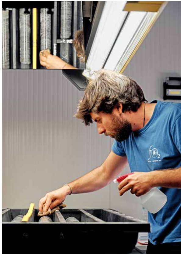
Geologe Othmar Müntener zeigt die diamantbesetzten Bohrwerkzeuge und die Bohrkern (links), die Bohrungsleiter Marco Vernier von der Uni Triest sorgfältig poliert, sortiert und fotografiert, damit sie ihre Geschichte erzählen.
