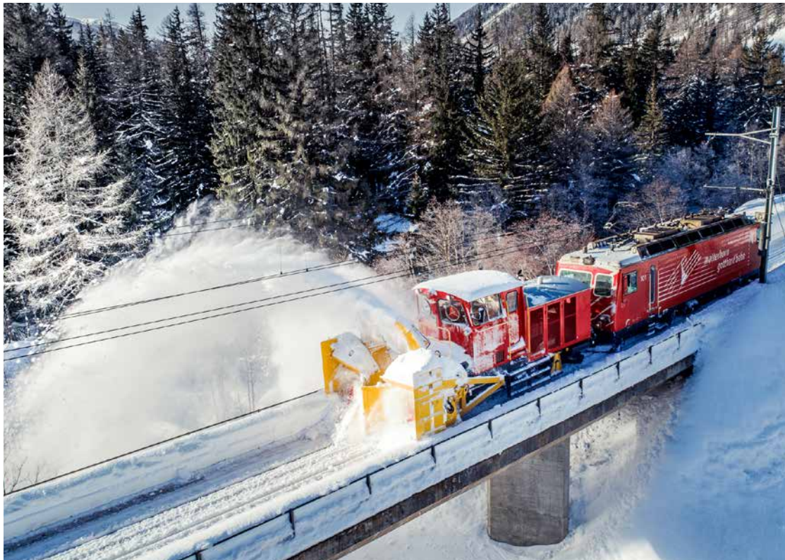
Die grosse Schneefräse wird am Gornergrat immer von einer leistungsfähigen Elektrolok geschoben. Doch wenn sich die Maschine durch eine Lawine (vorhergehende Seite) oder durch schweren Nassschnee fressen muss, kommt selbst dieses kräftige Gespann an seine Grenzen.
